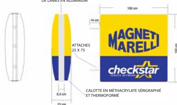
ÉQUIPEMENT ÉLECTRIQUE COMPOSÉ DE LAMPES FLUORESCENTES 3 X 30W AVEC CABLE AUX NORMES CE/INI CE
