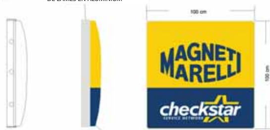
CALOTTE EN MÉTHACRYLATE SÉRIGRAPHIÉ ET THERMOFORMÉ
